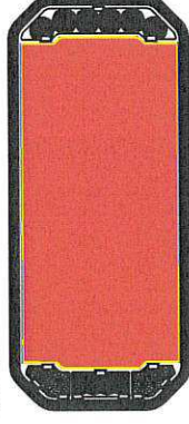
POWIERZCHNIA EMITUJĄCA ŚWIATŁO POZYCZYJNE TYLNE W301/R1 LIGHT EMITTING SURFACE OF THE REAR POSITION LIGHT W301/R1
