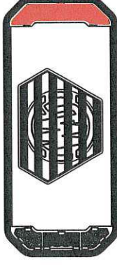
POWIERZCHNIA EMITUJĄCA ŚWIATŁO HAMOWANIA W279/S1 LIGHT EMITTING SURFACE OF THE STOP LIGHT W279/S1
