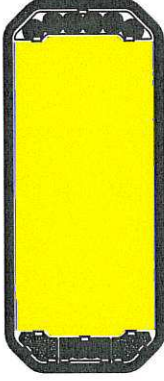
POWIERZCHNIA EMITUJĄCA ŚWIATŁO KIERUNKU JAZDY W301/2aD LIGHT EMITTING SURFACE OF THE REAR DIRECTION INDICATOR LIGHT W301/2aD
